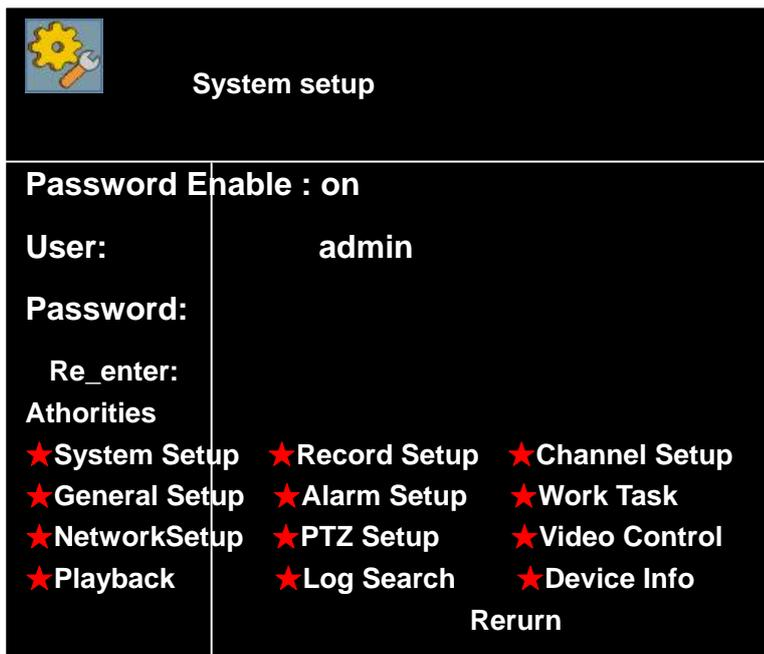
◆ **Password Function:** As the screen above, move the cursor to 『Password Function』, press 『ENTER』 to select On or Off.
